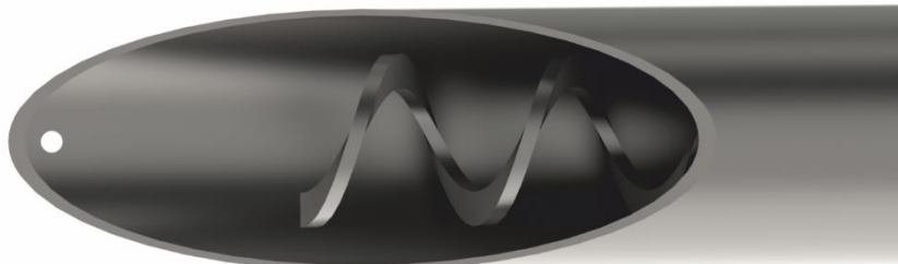
Rys.6. Montaż spirali podajnika.
